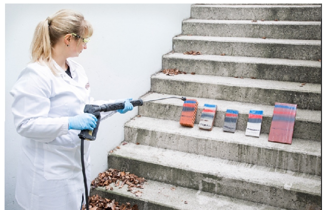
4. Az eredmény lenyűgöző: a graffitik vízzel lemoshatóak a kereskedelemben kapható magasnyomású mosóval.
